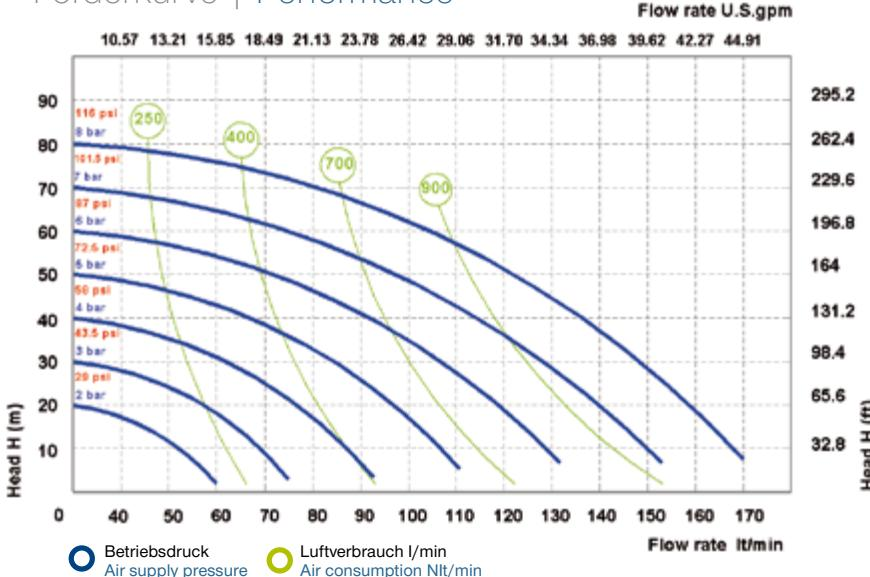
Die Kurven und Leistungswerte beziehen sich auf Pumpen mit getauchter Saugleitung bei freiem Auslauf mit Wasser bei 20°C und variieren je nach Material. | The curves and performance values refer to pumps with submerged suction and a free delivery outlet with water at 20°C, and vary according to the construction material.
