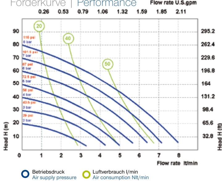
Die Kurven und Leistungswerte beziehen sich auf Pumpen mit getauchter Saugleitung bei freiem Auslauf mit Wasser bei 20°C und variieren je nach Material. | The curves and performance values refer to pumps with submerged suction and a free delivery outlet with water at 20°C, and vary according to the construction material.
