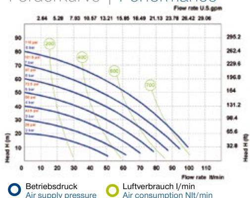
Die Kurven und Leistungswerte beziehen sich auf Pumpen mit getauchter Saugleitung bei freiem Auslauf mit Wasser bei 20°C und variieren je nach Material. | The curves and performance values refer to pumps with submerged suction and a free delivery outlet with water at 20°C, and vary according to the construction material.
