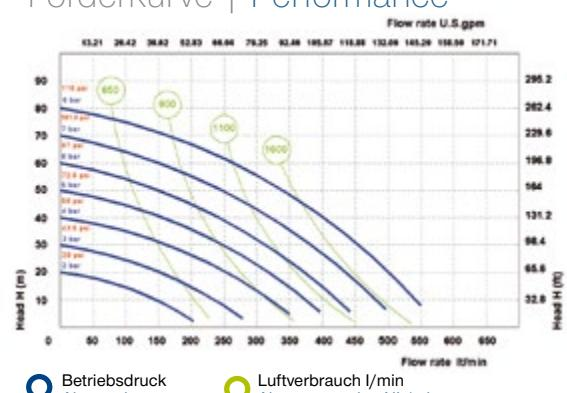
Die Kurven und Leistungswerte beziehen sich auf Pumpen mit getauchter Saugleitung bei freiem Auslauf mit Wasser bei 20°C und variieren je nach Material. | The curves and performance values refer to pumps with submerged suction and a free delivery outlet with water at 20°C, and vary according to the construction material.
