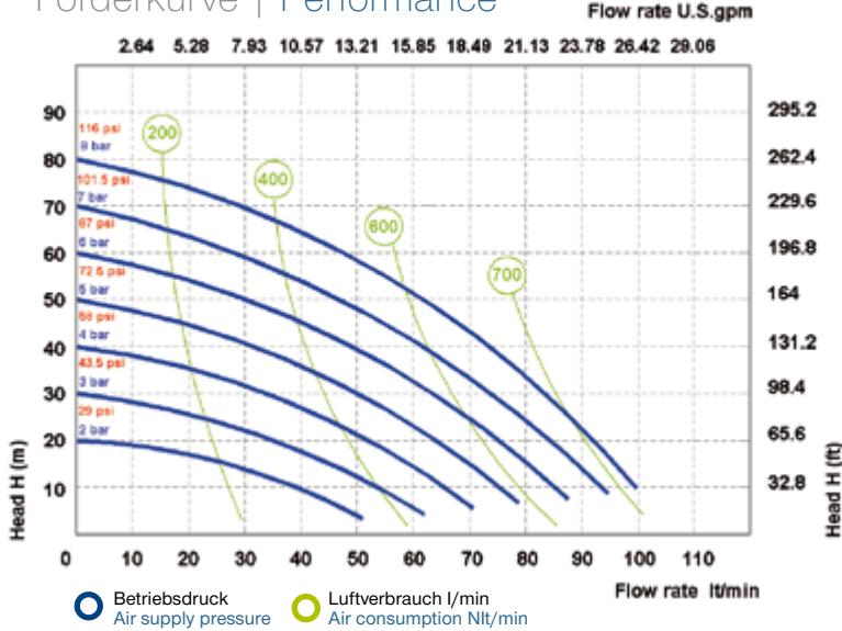
Die Kurven und Leistungswerte beziehen sich auf Pumpen mit getauchter Saugleitung bei freiem Auslauf mit Wasser bei 20°C und variieren je nach Material. | The curves and performance values refer to pumps with submerged suction and a free delivery outlet with water at 20°C, and vary according to the construction material.
