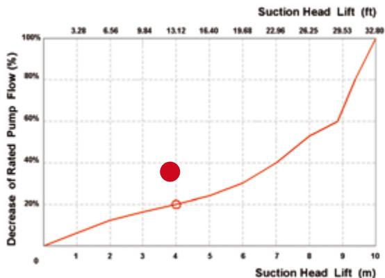
Bei einer Saughöhe von 4 m sinkt die Pumpenleistung um ca. 20%. Gültig für Pumpen 3/4" und größer; Daten variieren mit der Pumpenkonfiguration.
