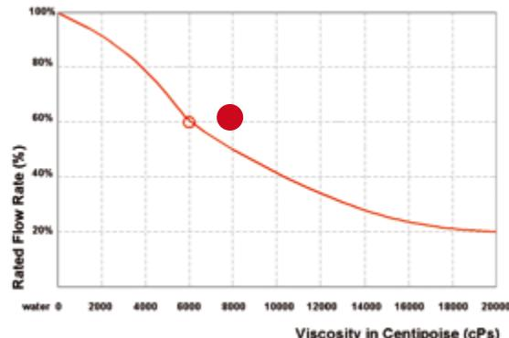
Während des Transports eines Fluids mit einer Viskosität von 6.000 mPas sinkt die Pumpenrate auf 60% ihres Nennwertes (100% = Wasser). Gültig für 3/4" Pumpen und größer.
